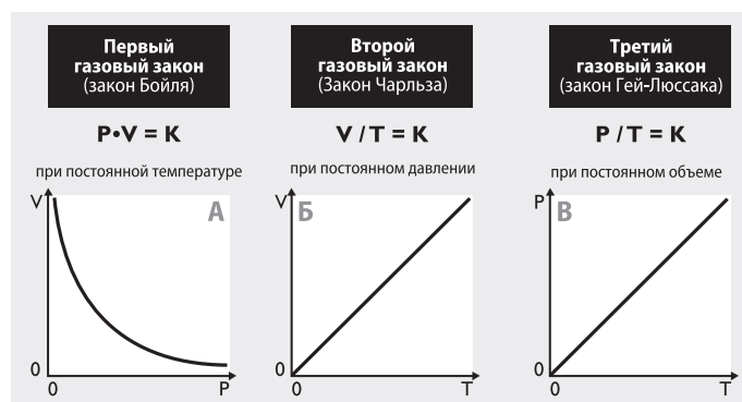
Рисунок 2. Три газовых закона
