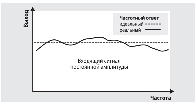
Рисунок 13. Нелинейность частотной характеристики
